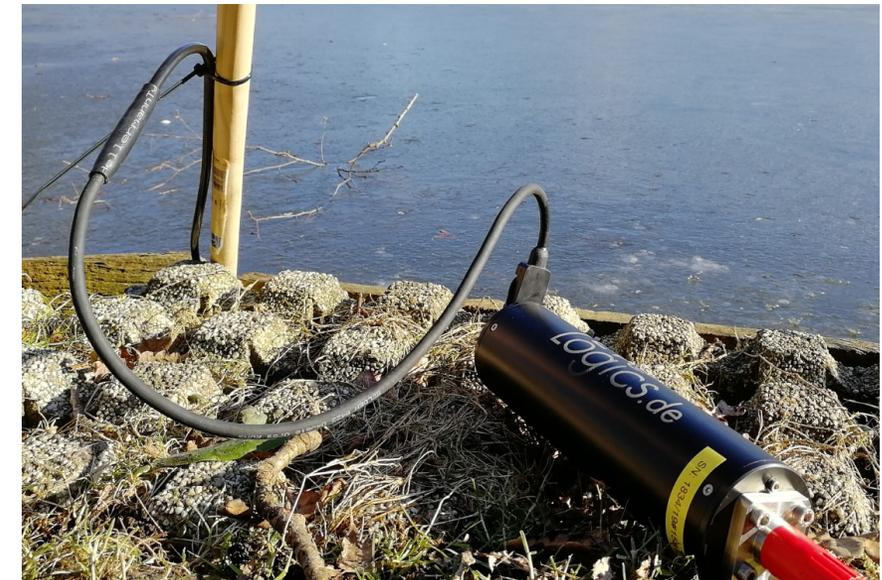
**Abb. 7:** Akustik Modem (Antenne im Wasser)
