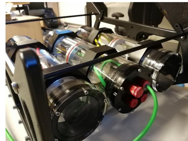
**Abb. 4:** Stereokamerasystem
