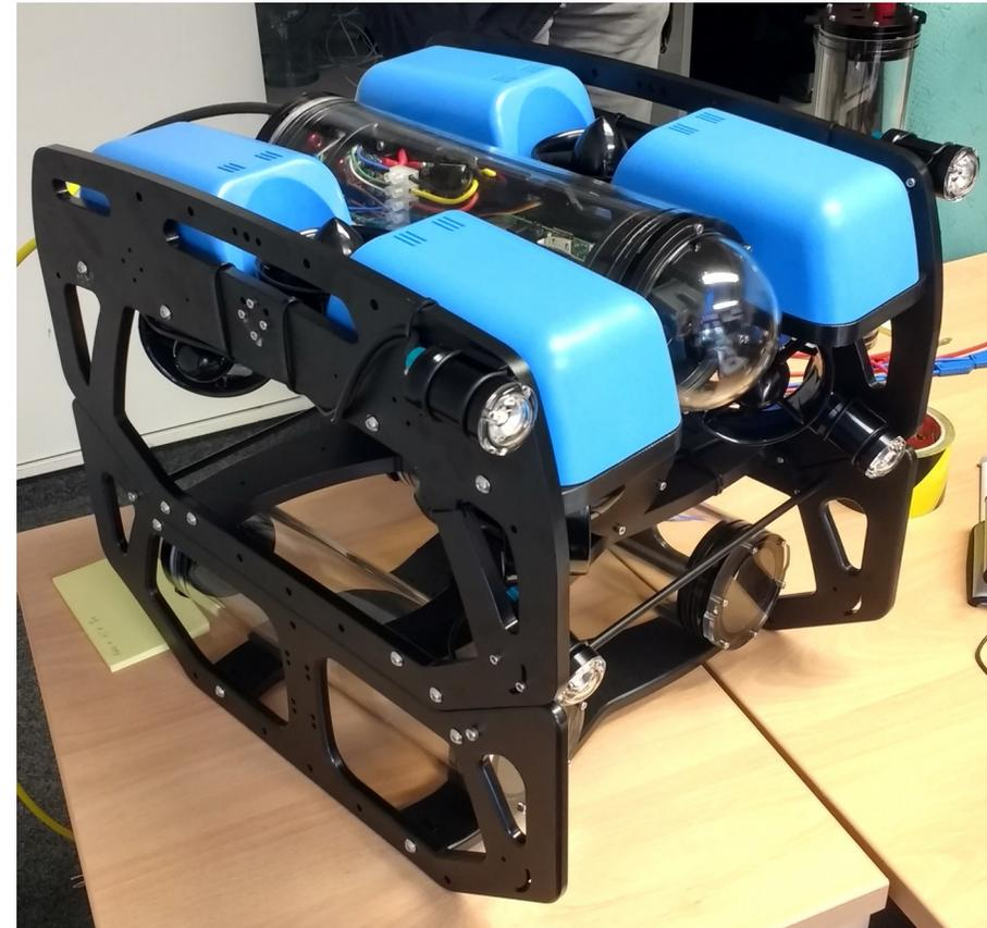
**Abb. 6:** Montiertes Payload Skid dient zur Anbringung zusätzlicher Hardware
